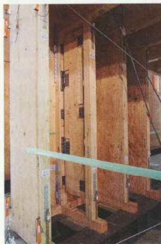
〔写真13〕幅600mmの壁4枚で偏心を抑える
